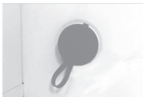
Fig. 5 Tapones de plástico para desagüe de agua de condensación (el tapón impermeabiliza el lado interno de la cuba)
