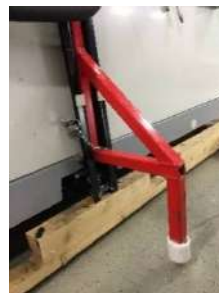
Fig. 7.1 : Sécurité anti-basculement Mise en service
