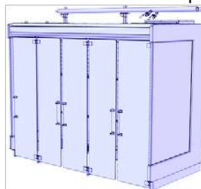
Fig. 11: dispositivo "ROLL-IN" com portas de vidro (GD) fechadas
