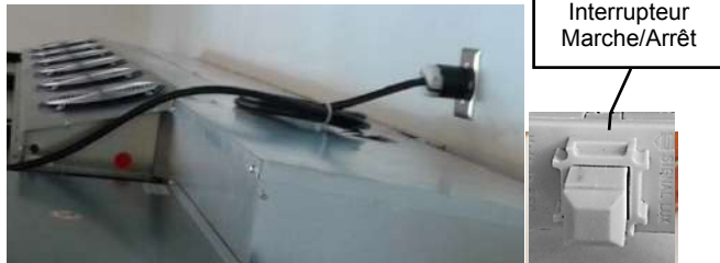
Fig. 8.2 : Raccordement de l'appareil au réseau 208-240V et interrupteur Marche/Arrêt (représentation symbolique)
