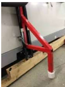
Fig. 7.1: sicura antiribaltamento del servizio di installazione
