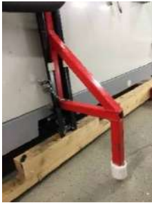
Fig. 7,1: Serviço de instalação da proteção anti-inclinação
