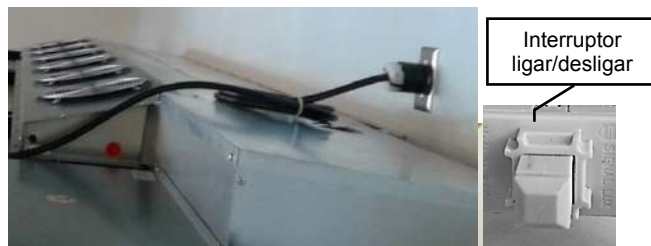
Fig. 8,2: Rede de 208-240 V para ligação do dispositivo e interruptor Ligar/desligar (visor de símbolos)
