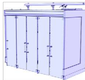
Abb. 11: „ROLL-IN“-Gerät mit Glastüren (GD) im geschlossenen Zustand
