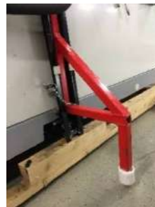
Fig. 7.1: seguro antivuelco del servicio de emplazamiento
