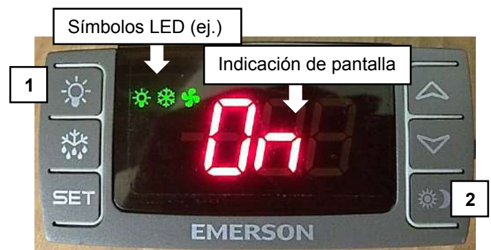
Fig. 4: elemento de mando e indicaciones de la pantalla (representación gráfica)
