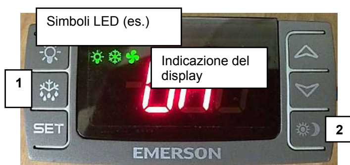
Fig. 4: Elemento di comando e indicazioni del display (illustrazione a tipo di esempio)
