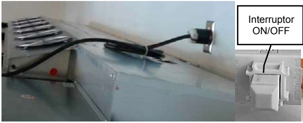
Fig. 8.2: conexión de equipos red 208-240 V e interruptor ON/OFF (representación simbólica)
