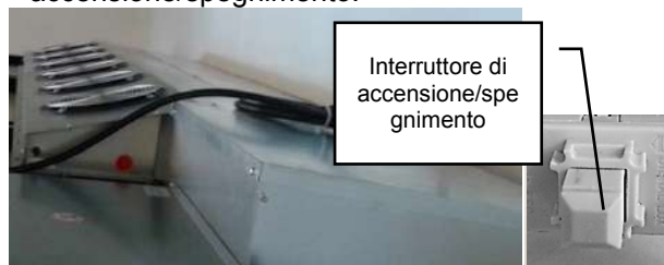
Fig. 8.2: collegamento dell'attrezzatura a rete da 208-240 V e interruttore di accensione/spegnimento (raffigurazione a titolo d'esempio)
