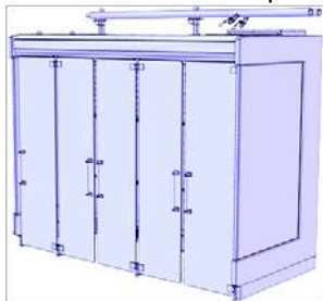
Fig. 11: equipo «ROLL-IN» con puertas de cristal (GD) en estado cerrado
