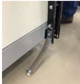
Fig. 7,2: Proteção contra inclinação específica do dispositivo
