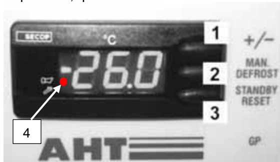
Fig. 3 : Régulateur électronique, éléments de commande et affichages à l'écran
