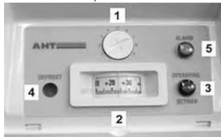
Fig.1.1: Regulador mecánico de la serie (-) Elementos de mando e indicadores
