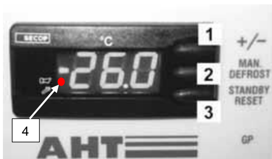
Fig.3: regulador eletrônico, elementos de controlo e indicações do visor
