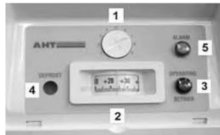
Abb.1.1: Mechanischer Regler bei Baureihe (-) Bedienungselemente und Anzeigen
