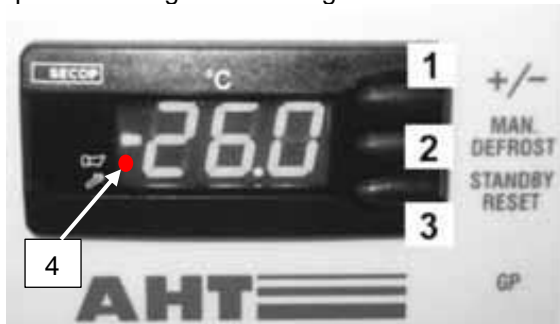
Fig.3: Regulador electrónico, elementos de mando e indicadores de pantalla
