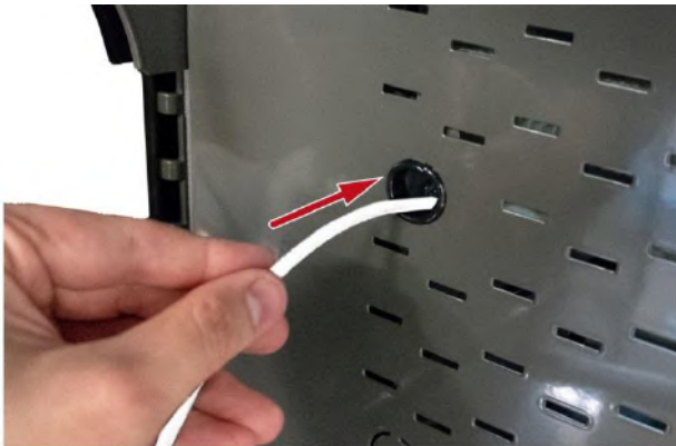
Abb. 9: Verbindungskabel hinter Rückwand verstauen
