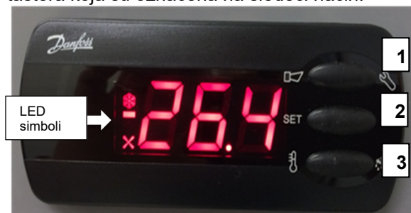
Sl. 2 Tip regulatora Danfoss - upravljački elementi i prikaz na displeju (prikaz simbolima)
