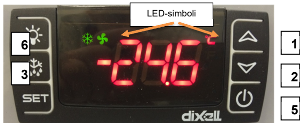
Sl. 3 Tip regulatora DIXELL; upravljački elementi i pokazivači na displeju (prikaz simbolima)
