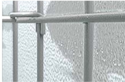
2.) Schmelzen der Eisschicht während der Enteisung
