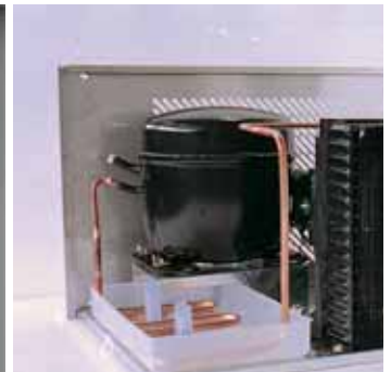
Automatische Tauwasserverdunstung durch Heißgas
